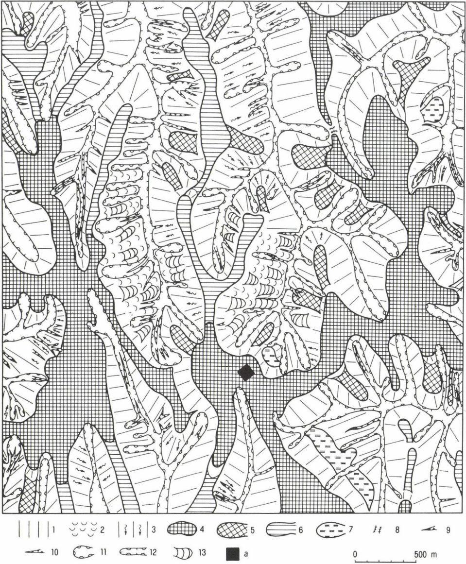
3. ábra. Az Ófalu mellé tervezett hulladék lerakóhely környezetének geomorfológiai térképe (Szerk.: SCHWEITZER F. 1990). – 1 = stabil lejtő; 2 = régi csuszamlásos felszín (csuszamlásveszélyes lejtők); 3 = barázdás eróziós lejtő; 4 = alacsony fennsík (250–300 m a tszf.); 5 = alacsony gerinc (200–250 m a tszf.); 6 = völgyközi hát (230–280 m a tszf.); 7 = lejtőpihenő; 8 = nyereg; 9 = eróziós vízmosások (1–5 m); 10 = eróziós árkok (5–10 m); 11 = deráziós völgy; 12 = eróziós-deráziós völgy; 13 = csuszamlások halmaza; a = tervezett lerakóhely
