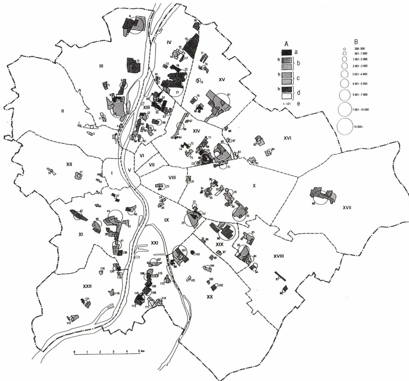
3. ábra. Budapest lakótelepei az 1990-es évek elején. – A = a lakótelepek építési időszaka: a = 1950-es; b = 1960-as; c = 1970-es; d = 1980-as évek; h = házigyári (nagypaneles) technológia alkalmazása; B = a lakások száma; 1–121 = a lakótelepek száma
