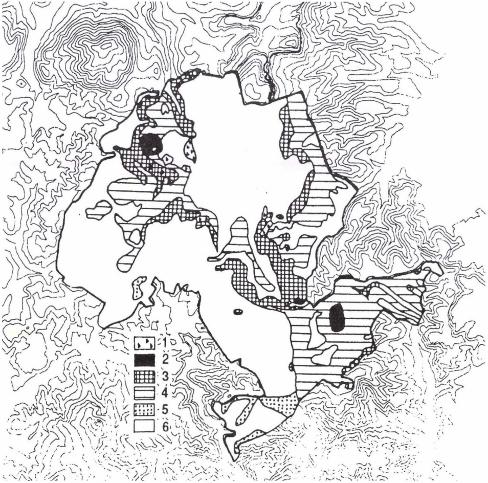
6. ábra. A Medves és környékének felszínmozgás-veszélyességi térképe. (Szerk. KARANCSI Z.) – 1 = aktív felszínmozgásos terület; 2 = fokozottan felszínmozgásos terület; 3 = felszínmozgásos terület; 4 = potenciális felszínmozgásos terület; 5 = felszínmozgás szempontjából veszélytelen terület; 6 = meddőhányó, mesterséges feltöltés
