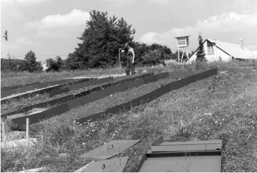
1. kép. A csákvári eróziós mérőállomás
