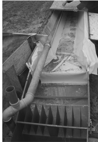
1. kép. A lefolyó vizet összegyűjtő tartályok és az elosztómű Runoff collecting tanks and the diffuser
