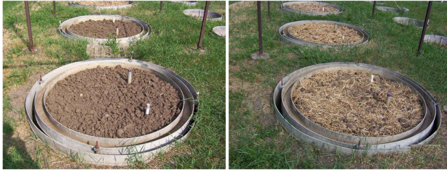
2. ábra. A hagyományos (balra) és a redukált (jobbra) talajművelési rendszerekre jellemző talajfelszínek szimulációja liziméterekben
