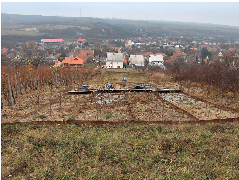
10. ábra. Geotextiliával és növényzettel fedett kísérleti Wischmeier–Smith eróziós mérőkeret (Fotó: JAKAB G. 2007)
