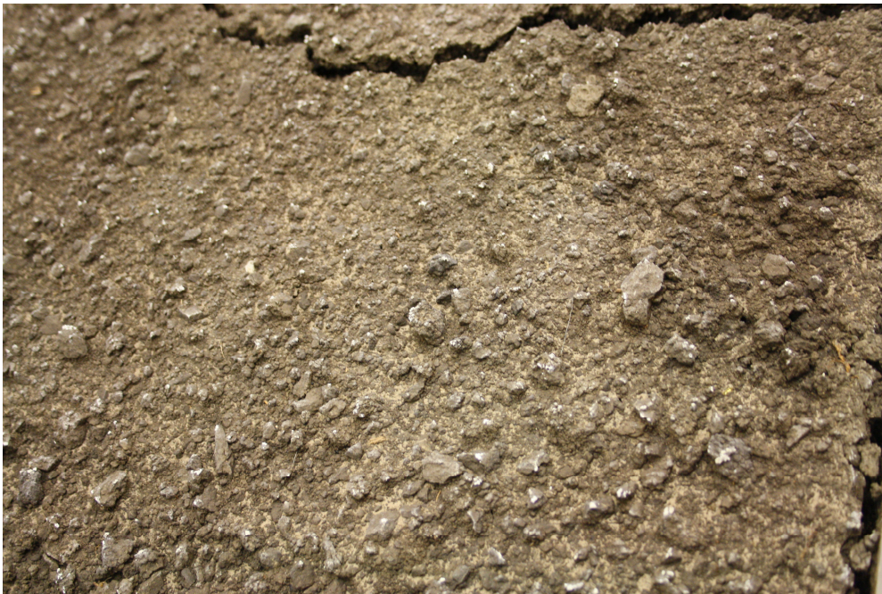
2. ábra Az esőztetett felszínen elkülönülő sötét aggregátumok és világos elemi szemcsék Figure 2 Dark aggregates and pale individual particles on the surface after artificial rainfall
