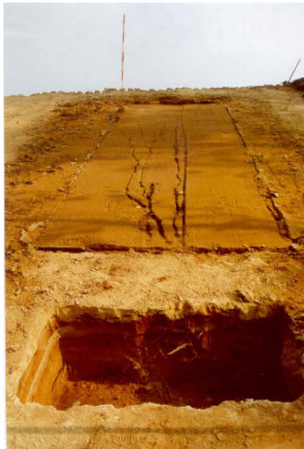
13. ábra. A vonalas erózió nyomai a fedetlen parcellán, az eső-szimulátoros mérések után (Fotó: JAKAB G. 2004) Figure 13 Traces of rill erosion on an uncovered plot following rainfall simulation measurements (Photo by JAKAB, G. 2004)
