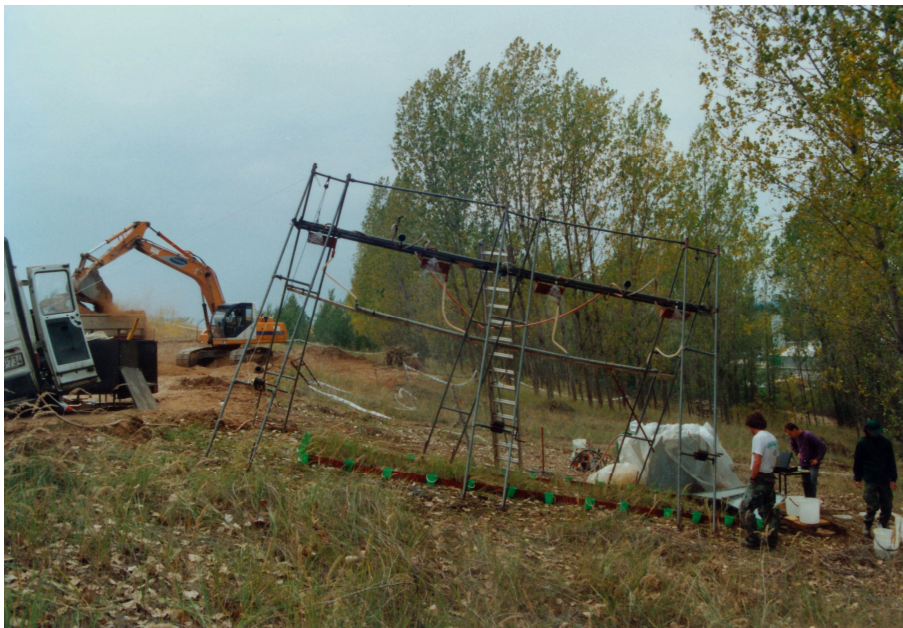
11. ábra. Eső-szimulátorral végzett mérések épített rézsűszakaszon (Fotó: SZALAI Z. 2004) Figure 11 Monitoring measurements with rainfall simulator on artificial scarp (Photo by SZALAI, Z. 2004)
